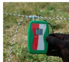
Stängslets effektivitet är direkt beroende av dess skick. Installera omsorgsfullt band, rep och isolatorer. Vegetation som rör stängslet stör stängselledningen och minskar på stängslets effektivitet. Kontrollera stängslets skick regelbundet!
