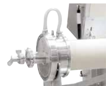
Водоохлаждаемый вакуумный фланец (пакет для газации 2)
