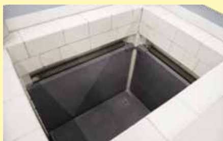
Футеровка сторон и днища с защитой пластинами из карбида кремния у шахтной печи S 73/HS
