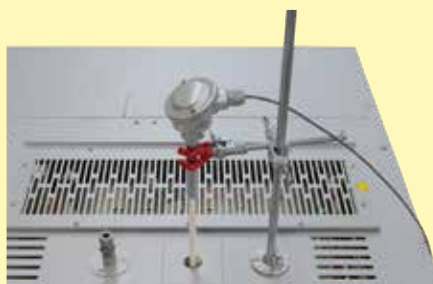
Термоэлементный ввод в потолок со штативом
