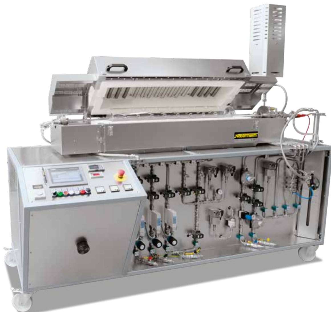
RSRB 170/1000/11 H 2 с пакетом для газации 4 для работы в водородной среде
