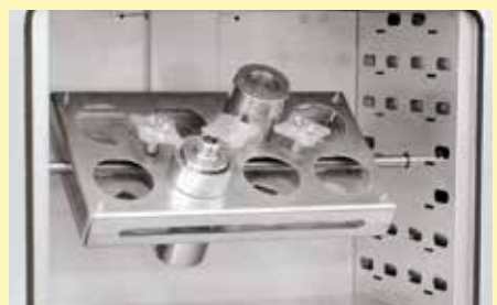
Электрическое поворачивающее устройство (здесь со специфической платформой заказчика для емкости PARR)
