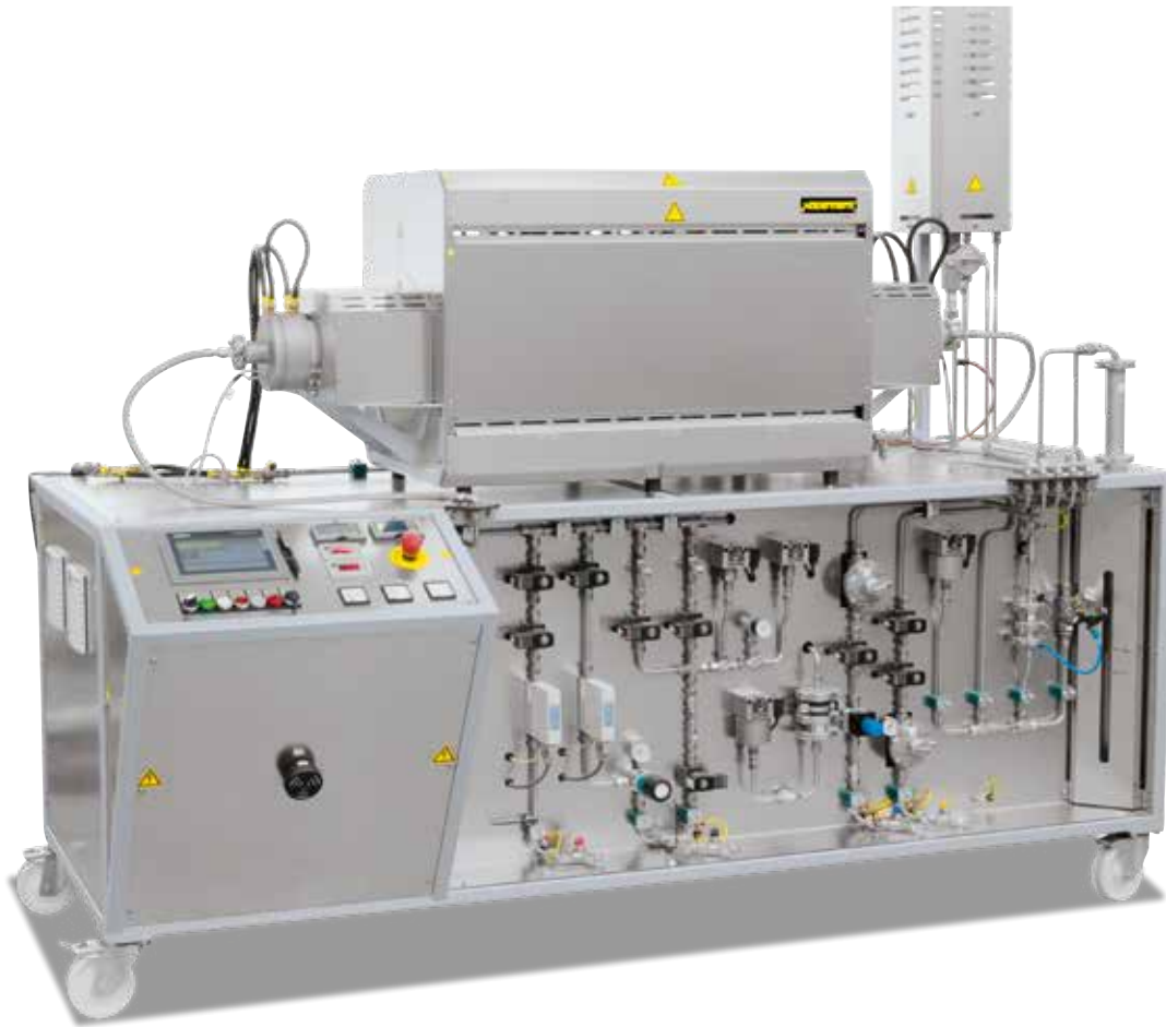
RHTH 120/600/18 с пакетом для газации 4 для работы в водородной среде
