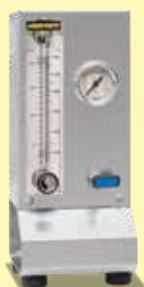
Газовая панель для негорючего защитного или реакционного газа (N 2 , Ar, He, CO 2 , воздух, формовочный газ)
