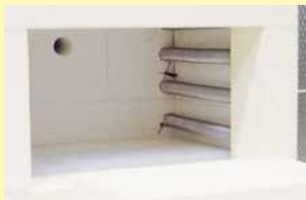
Внутреннее пространство печи с высококачественной изоляцией огнеупорным легковесным кирпичом
