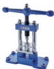
С 21 Пресс-гранулятор Ручной пресс для порошкообразных, легко сжигаемых субстанций Идент. No: 0001605300
